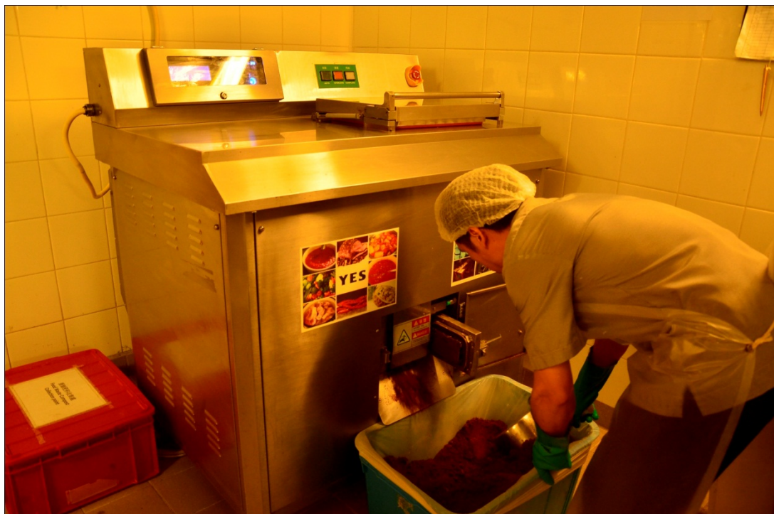
P002: 经厨余机分解处理后，厨余会转化成有用的有机肥料，能灌溉渡假城的苗场及花卉。
